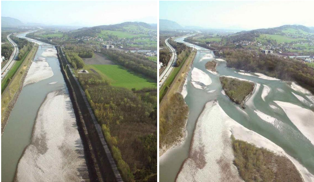
Alpenrhein zwischen Schaan-Buchs und Bendern-Haag links: Status quo, rechts visualisierte Aufweitung (Foto und Visualisierung: Internationale Rheinregulierung & Hydra Institute)
